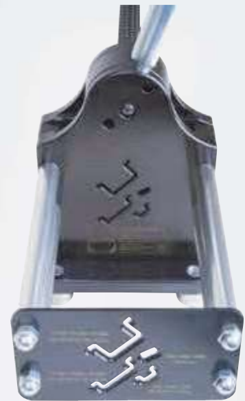
Dispositif de guidage pour la découpe précise d'angles à 90°
