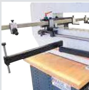
Butées longitudinales et de profondeur montées des deux côtés dans des guidages à billes doubles. 2 butées réglables à droite et à gauche sur l'axe Y.
